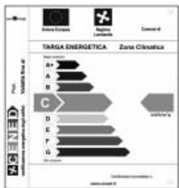
Esempio di targa energetica: nel modello proposto dalla Regione Lombardia il parametro che definisce la classe si riferisce al fabbisogno specifico di energia primaria per il riscaldamento dell'edificio.
