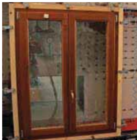
I test per la resistenza a vento, aria ed acqua sono ormai indispensabili per certificare la qualità delle finestre prodotte
