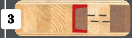
Sezione pannello Legno massello e fibra di legno legata con paraffina
